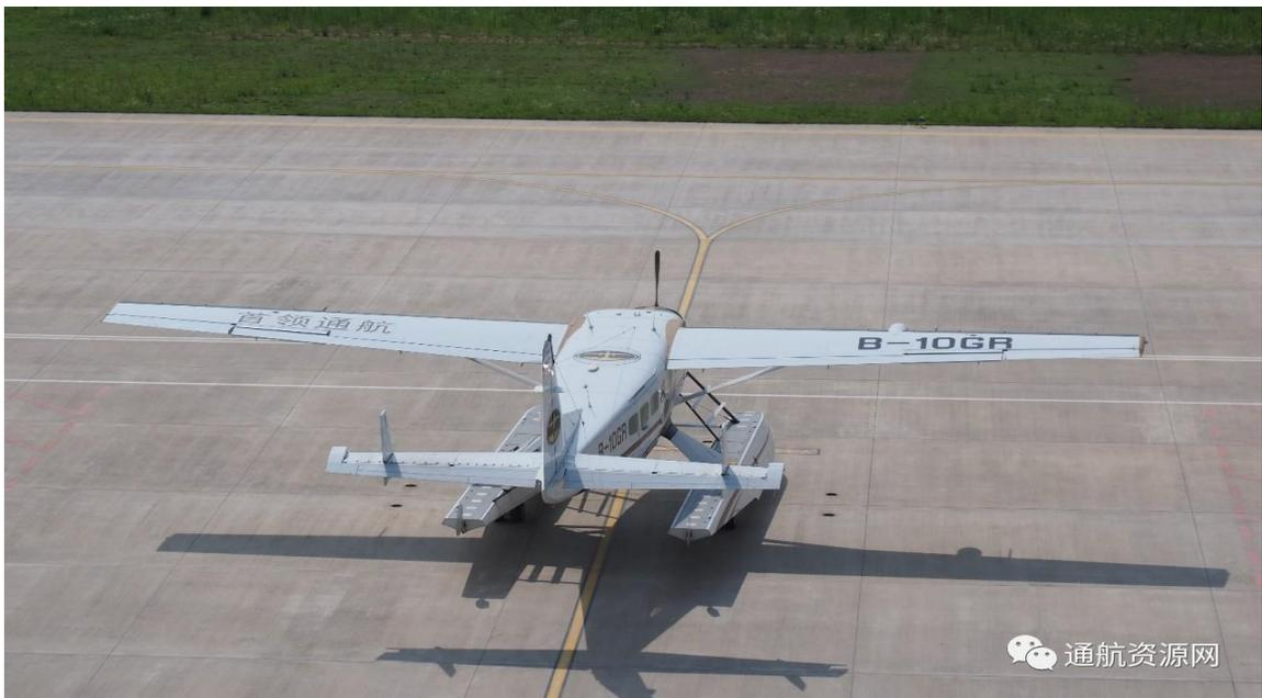
赛斯纳 208EX 加长型大篷车水陆两栖型飞机采用加拿大普惠 PT6A-140 发动机，867 轴马力的强劲动力和 610 米的水上起飞距离确保飞机在短距水路和恶劣环境中也能够顺利起降，并可轻松越过湖岸障碍。
