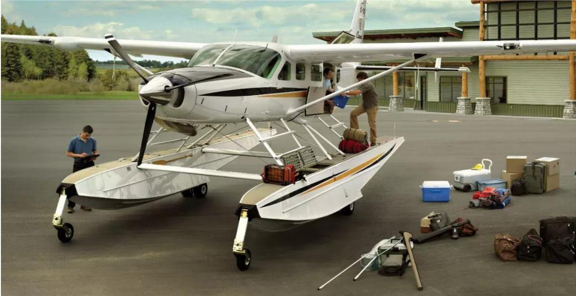
该机型的可用载荷高达 1416 公斤，宽大的货舱门方便装卸大宗货物、重型设备和装置。两侧浮筒各设有宽敞、防滑的通道和两个承载力达 68 公斤的储物箱。不论是运送乘客或运输货物，赛斯纳 208EX 加长型大篷车水陆两栖型飞机均可根据任务类型量身打造客舱布局，客舱使用耐用抗污渍的乙烯基地板，在海洋环境中易于维护，豪华内饰为乘客带来极致的飞行体验。
