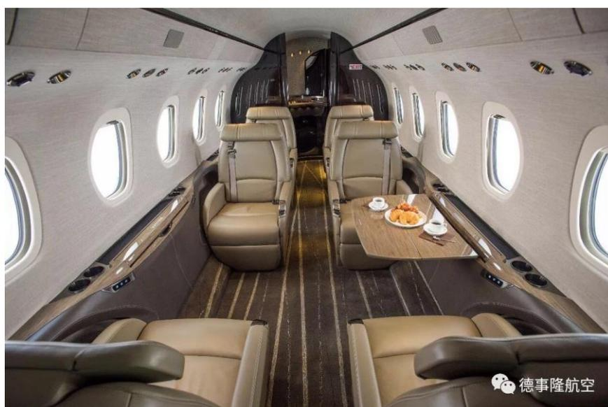
奖状 680A 纬度配备德事隆航空无线客舱管理系统，乘客可通过其个人电子设备享受美好的机载互联体验和机上娱乐服务。全新的机舱制冷系统和增压系统为乘客和机组打造更为舒适的飞行环境，飞机在 13716 米（45000 英尺）的最大运行高度巡航时，座舱气压高度仅为 1814 米（5950 英尺）。奖状 680A 纬度的标准座椅布局可搭载 9 名乘客，为机主提供最佳飞行体验。延长的维修间隔令机主能享受到中型商务机领域最低的直接运营成本。
