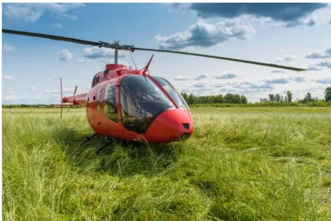
贝尔 505 Jet Ranger X 早前已在全球多地展示了其卓越的性能表现，覆盖亚洲、欧洲、北美和拉丁美洲的路演活动目前仍在进行当中。贝尔 505 Jet Ranger X 在经典的 Jet Ranger 家族基础上，搭载了全新且先进的航电技术。该机可靠、快速、性能与操纵俱佳，并拥有平直的客舱地板和开阔的客舱空间，能够适配多种不同的任务布局并搭载各类任务载荷。宽敞的客舱在行政布局下可以搭载 4 名乘客，或快速拆除客舱座椅使之胜任货运任务。贝尔 505 还拥有可靠的传动和旋翼系统，而所有的这一切使得贝尔 505 成为了一款真正的轻型单发多用途直升机。
