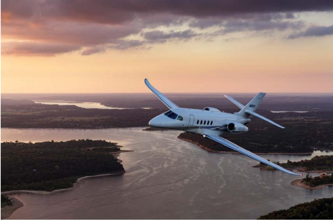
赛斯纳奖状 680A 纬度的最大航程为 5278 公里（2850 海里），搭载 4 名乘客可高速巡航 5000 公里（2700 海里），优于同级别其它机型。相较竞争机型，奖状 680A 纬度拥有更开放、宽敞、明亮和精致的客舱环境。客舱高 1.83 米，拥有平坦的地板，独特性能蕴含科技创新贯穿整个飞机设计。奖状 680A 纬度配备德事隆航空无线客舱管理系统，乘客可通过其个人电子设备享受美好的机载互联体验和机上娱乐服务。全新的机舱制冷系统和增压系统为乘客和机组打造更为舒适的飞行环境，飞机在 13636 米（45000 英尺）的最大运行高度巡航时，座舱气压高度仅为 1803 米（5950 英尺）。奖状 680A 纬度的标准座椅布局可搭载 9 名乘客，为机主提供完美的飞行体验。
