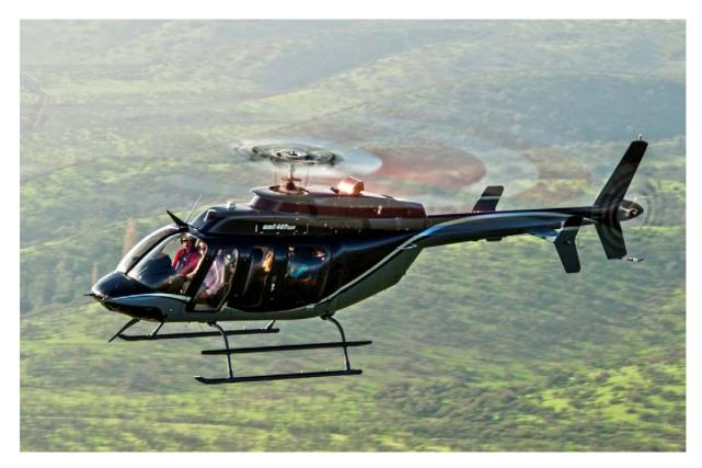
贝尔于 2015 年推出的 407GXP 型直升机是基于贝尔 407 直升机的升级款,增加了 50 磅(22.5 公斤)的有效载荷,通过配备罗罗 M250 发动机对飞机性能和燃油效率的提升,贝尔 407GXP 能提供同级别产品中最领先的高温高原性能。除此之外,贝尔 407GXP 配置了如具有改进的悬停性能计算器等新的航电系统,并在原有的主减速器的大修间隔基础上增加 500 小时以大幅度降低维修成本。
