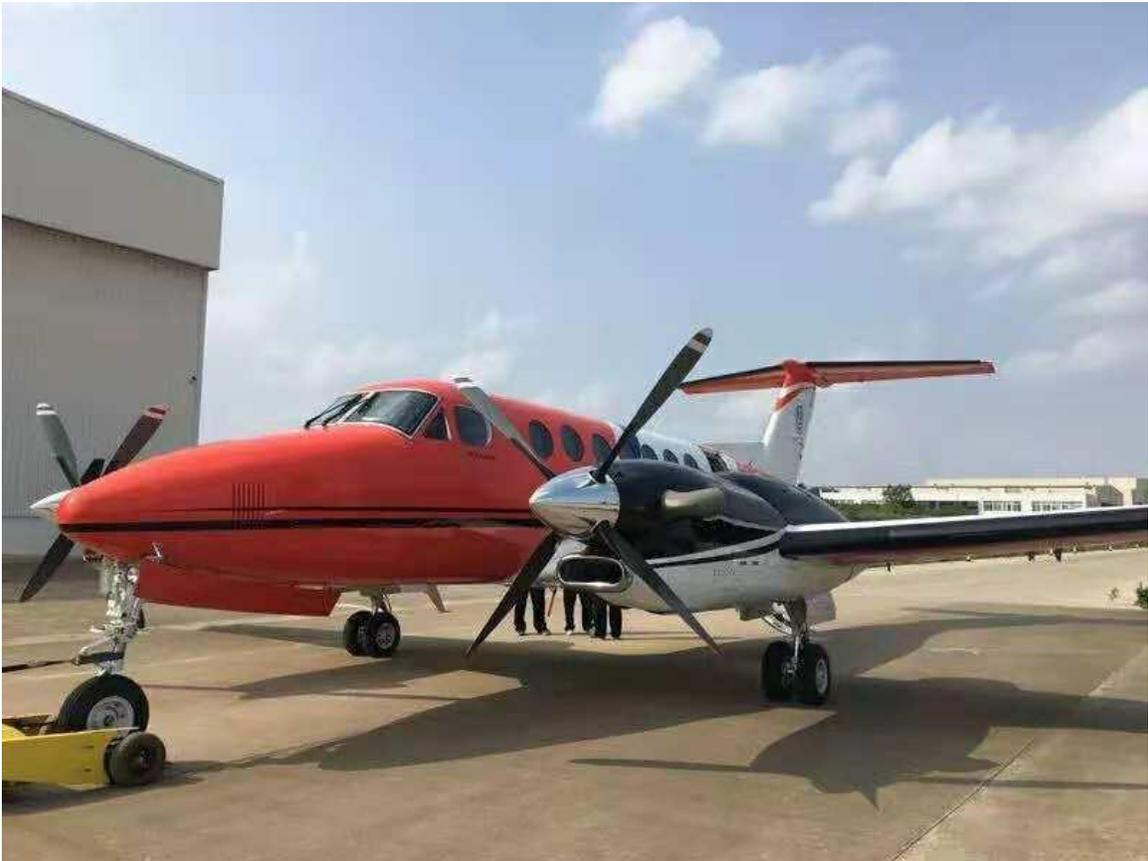
空中国王350ER飞机机长14.22米，翼展17.66米，巡航高度为300米~1500米，巡航速度达333公里/小时，东方通航用该机型替换了此前执行任务的空中国王B-200飞机。上海海事局向东方通航租赁飞机，主要是在东海海区和上海港水域开展海上空中巡航作业，包括做好监视船舶污染，应对突发事件，巡查通航环境，巡视助航设施，巡视专属经济区、维护国家海洋权益等，提供全方位和专业性的技术保障。
