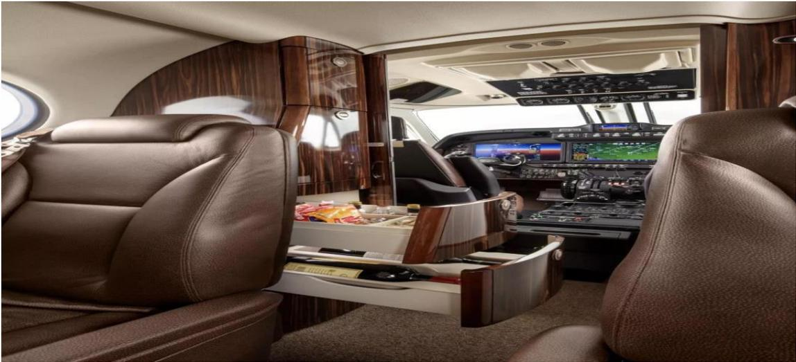
同时，飞机驾驶舱还配备了全触屏 Pro Line Fusion 航电系统，让飞行员从繁重的数据检索工作中解脱出来，全神关注飞行，保障安全。
