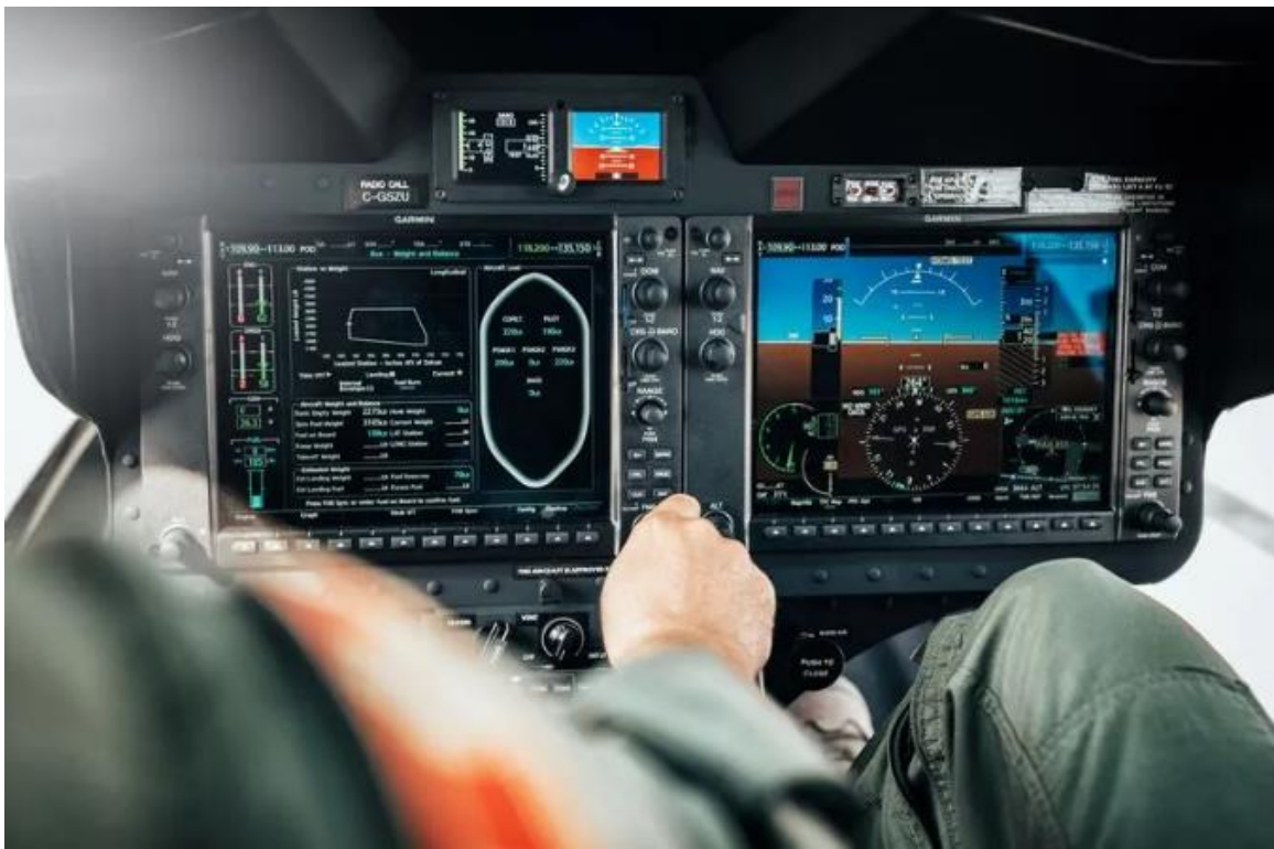
贝尔 505 NXi 搭载的 G1000 NXi 航电系统
